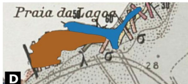
figura 25.7 _ A digitalização de polígonos adjacentes é feita tendo a opção de “snapping”. Na janela de [Ajustes de Snapping]. (A) selecionar a opção [Não permitir sobreposições na camada ativa] (B). Ao digitalizar o polígono adjacente (C) os limites comuns são recortados. O resultado são dois polígonos com uma parte em comum (D)
