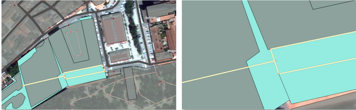
figura 6.3 _ Muito embora as linhas da estrada (amarelo) pareçam intercetar-se, na imagem da direita pode-se observar que há um problema de cruzamento das mesmas
